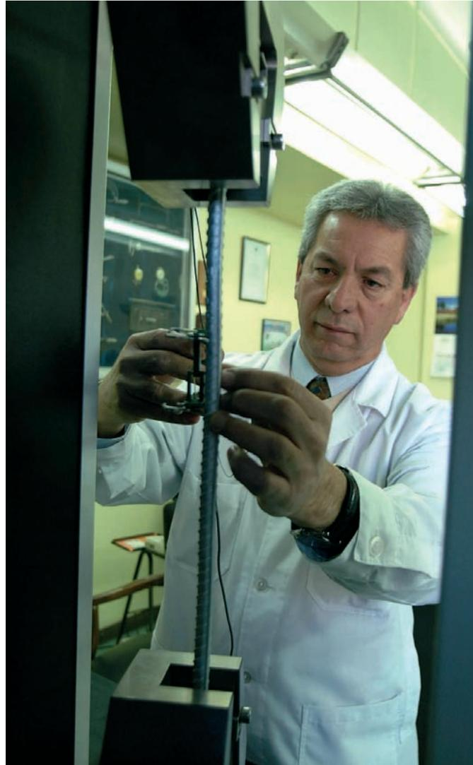
Los laboratorios de la Compañía cumplen con todos los criterios de calidad internacionalmente aceptados para realizar los dos principales ensayos que se practican al acero: análisis químico por espectrometría óptica y ensayo de tracción. Así lo certifica la acreditación entregada en 2005 por el Instituto Nacional de Normalización (INN) bajo la norma NCh-ISO 17025:2005
